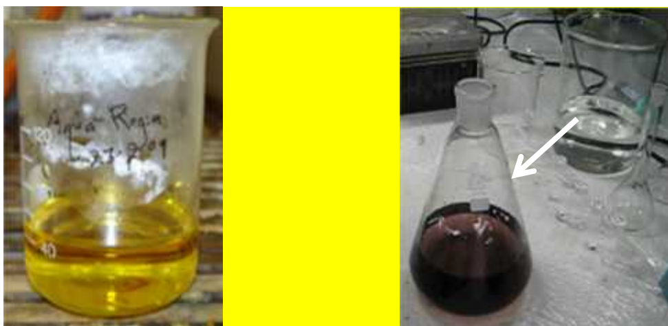
(a) Aqua Regia solution with dissolved gold precipitate
